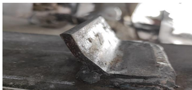
Figura 9. Deformación permanente en conectores Tipo 1 de 6 mm. Fuente: [4]
