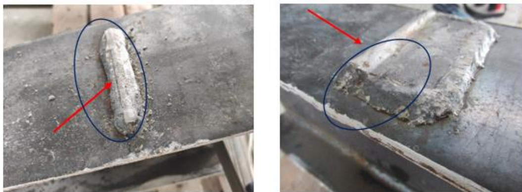
Figura 8. Fallas en los conectores, fracturas. Fuente: [4]
